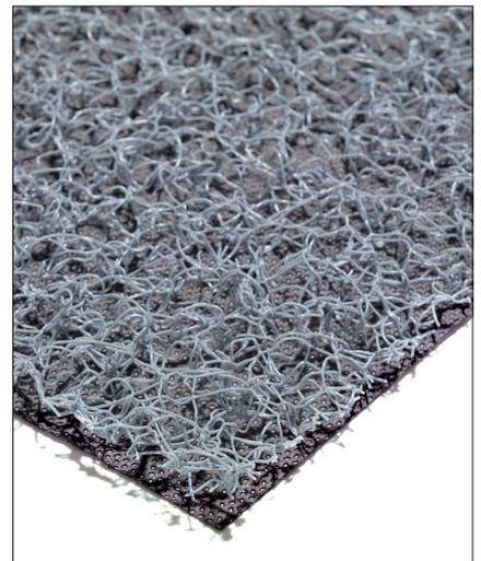
VAPOZINC ist ein Strukturgeflecht mit unterseitiger diffusionsoffener Schalungsbahn. Es führt etwaige Feuchtigkeit zwischen Unterkonstruktion und Dachdeckung sicher ab und kann sowohl auf Holzschalungen als auch auf großflächigen, nicht feuchtigkeitskompensierenden Untergründen wie Holzwerkstoffen oder trittfesten Dämmungen verlegt werden. Die dampfdurchlässige Schalungsbahn minimiert das Eindringen von Feuchtigkeit während der Bauphase und ermöglicht
